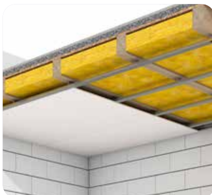
Izolacija spuščenega stropa
