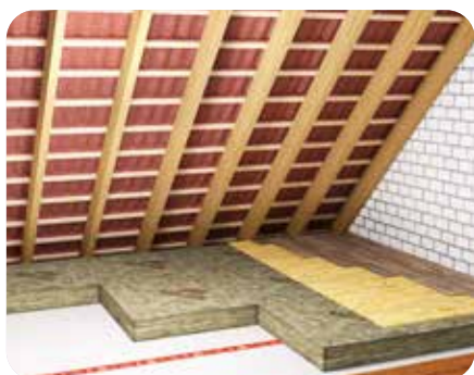
Izolacija pohodno / nepohodno podstrešje
